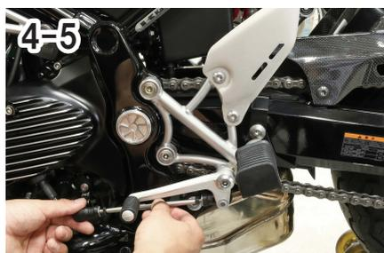
▶ ⑨ステップベースの穴②番に⑧平行ピンをセットし、③ステップアジャスター中央穴を合わせて⑬皿ボルト25mmで組み付けてください。
