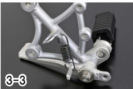
3-1で差した⑥皿ボルト45mmの余り部分に[A]ブレーキペダル&ワッシャーをセットし、④ピボットナットで組み付けてください。
