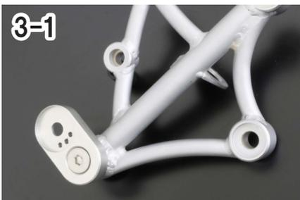
①ステップベースの穴⑧番に⑧平行ピンをセットし、③ステップアジャスター中央穴を合わせて⑥皿ボルト45mmで組み付けてください。
