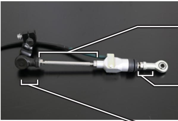
キット付属のロッドを使用し各 6mm 以上ねじ込むよう取り付けてください。
