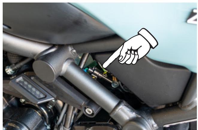
4) 純正のグリップヒーター用電源を利用し、ギボシを接続します。
