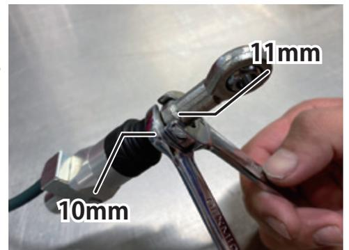
6) 下記を参考に各ボルトナットを締め付けます。
