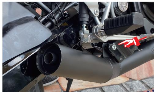
6) O2 センサーをコレクターへ仮止めし、カプラーを接続します。
