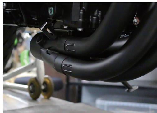
4) テールパイプ差し込み口の内側へカッパーグリスもしくは液体ガスケットを塗布し、コレクターへ差し込みます。
