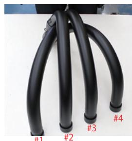
3) 付属の2ピースフランジを使用し、エキゾーストポートへ差し込み、STDナットを使用し仮止めします。
