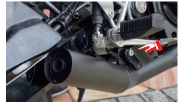
5) 画像の位置でテールパイプステーを付属のM10ボルトを使用し取り付け裏側からナットを締め付けます。
