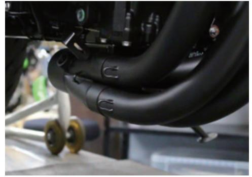
4) テールパイプ差し込み口の内側へカッパーグリスもしくは液体ガスケットを塗布し、コレクターへ差し込みます。
