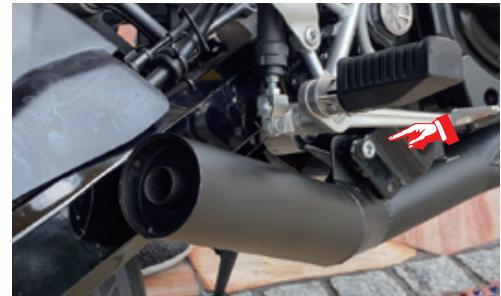
6) O2センサーをコレクターへ仮止めし、カプラーを接続します。
