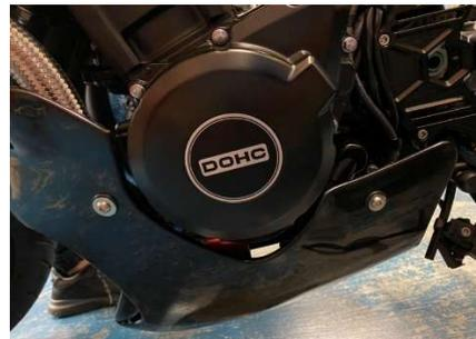
5.ステー取付穴に⑥⑦を取り付けた①本体を⑧⑨ボルト+ワッシャー(規定トルク10N/m)を取り付けて下さい。
