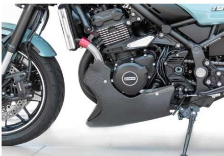
取り付け後(約100km)再度各部点検を行い、改めて増し締めを行って下さい。
