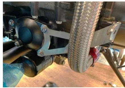
3.④左側前方マウントステー取付位置純正ボルトで共締めして下さい。
