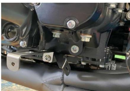
2.③右側後方マウントステーを純正ボルトで共締めしてください。
