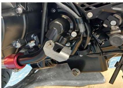
4.⑤左側後方マウントステー取付位置純正ボルトで共締めして下さい。
