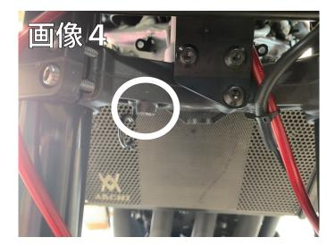
4. ①ステー本体に④ウェルナットをセットし、 ステムエンブレムに③丸皿ボルトを差し込み、 ④ウェルナットに固定してください。
